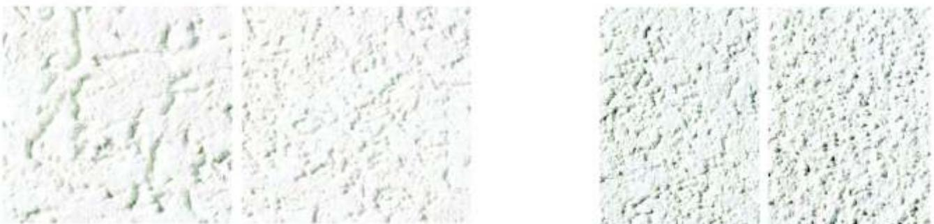
Штукатурка наносится на поверхность равномерным слоем шпателем либо кельмой. Окончательный рельеф придается поверхности теркой.
